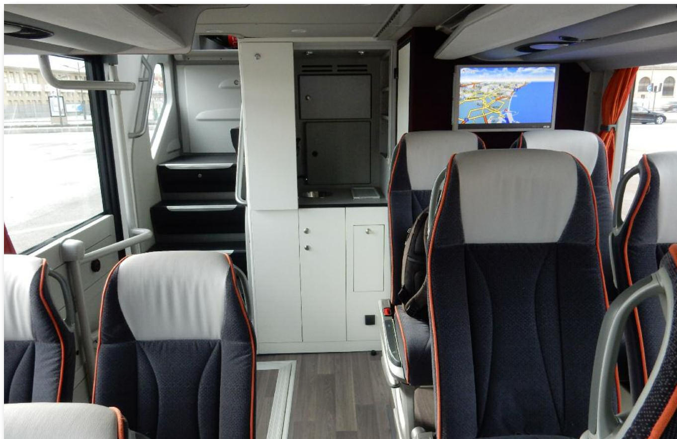
Bageste del i lavgulvsversionen, pantryet i midten, kørestolsrampen ses i gulvet.
